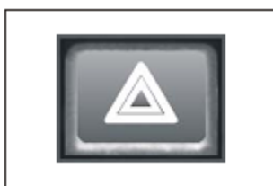
Obr. 5.4 . vypínač varovné signalizace
