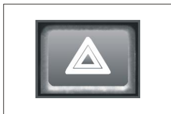
Obr. 5.15. vypínač varovné signalizace
