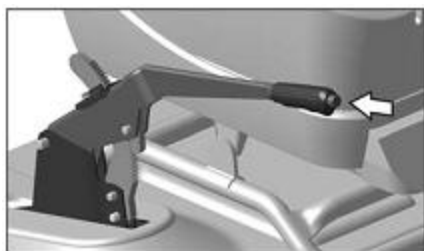
Obr . 5.8 . Páka ruční brzdy
