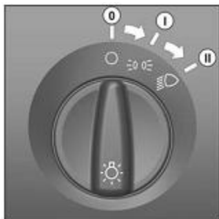
Obr . 5.2. Hlavní přepínač osvětlení
