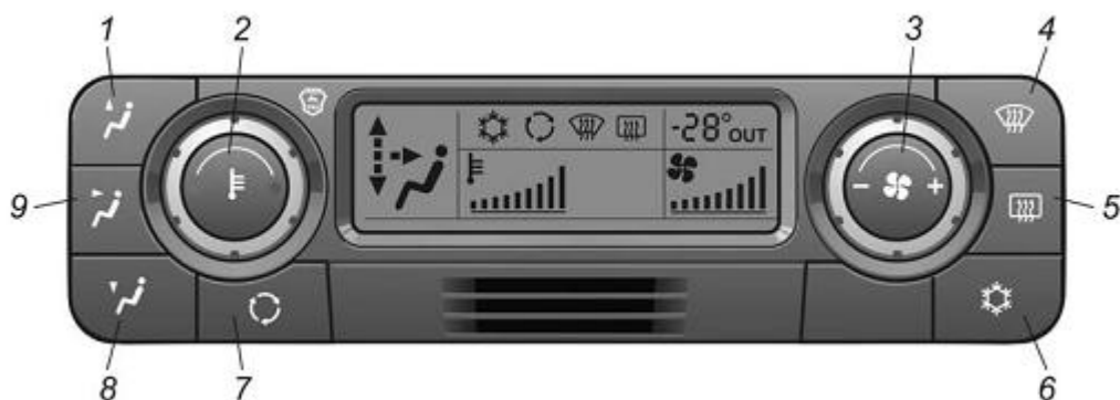
Obr. 8.1 . Dálkové ovládání topení a ventilace a klimatizace
